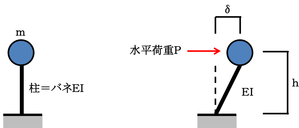
図1 バネの先に重りがあり振動する(固有周期)
